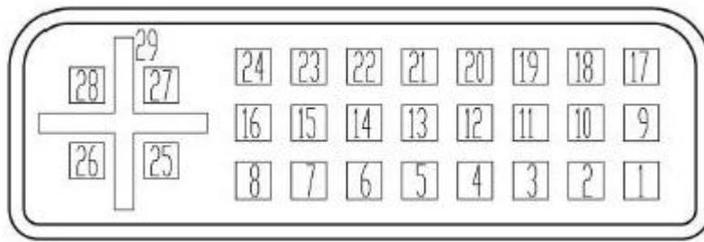
(图 1.1) 29PIN DVI-I 接口引脚定义 (P1)
